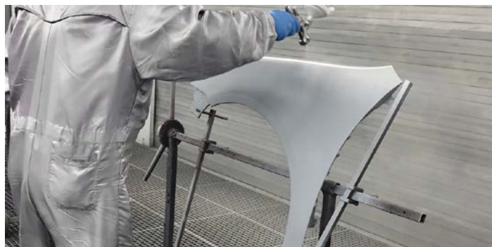
Die Lackierung mit Stickstoff reduziert das Overspray und liefert qualitativ hochwertige Beschichtungen. Foto: Kamatec
